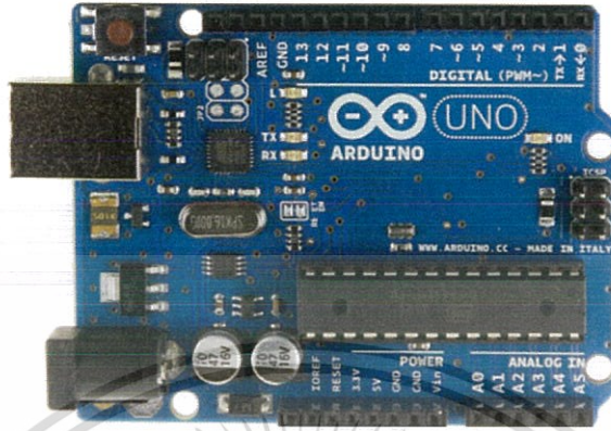
รูปที่ 3.3 Arduino UNO R3
