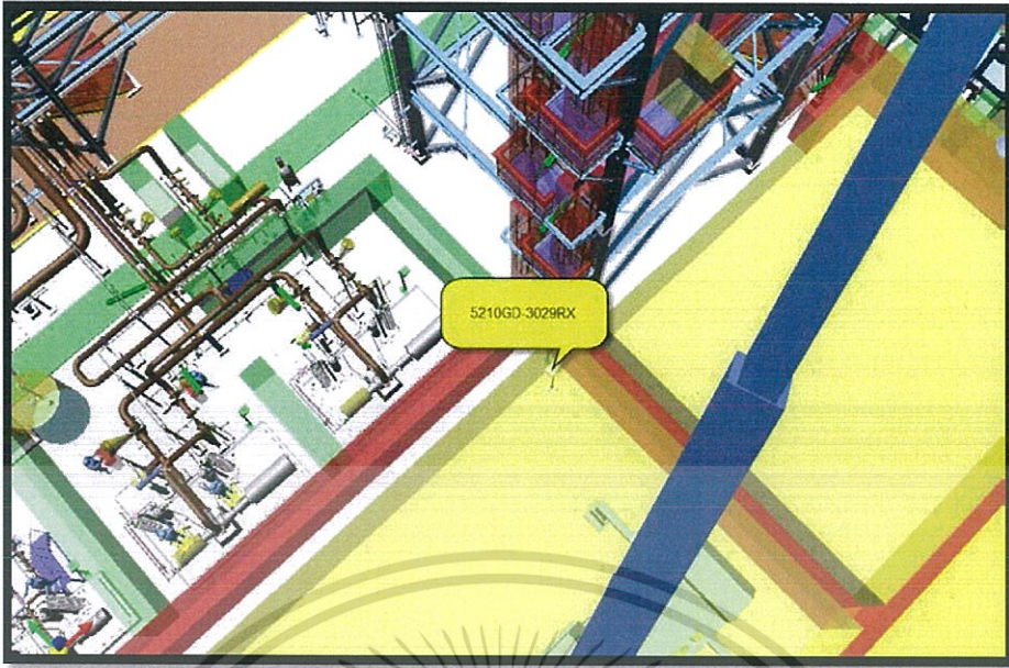
รูปที่ 4.36 จุดติดตั้งเครื่องตรวจจับก๊าซหมายเลข 5210GD – 3029RX
