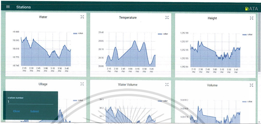
ภาพที่ 4.20 การทดสอบการเลือกหรือการเปลี่ยนสถานีของระบบวัดปริมาณน้ำมันอัตโนมัติ
