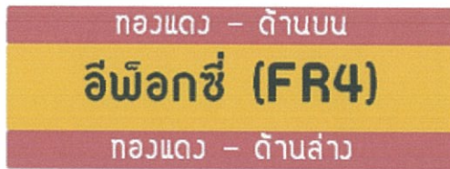
ภาพที่ 2.32 PCB ชนิดสองหน้า (Double Side PCB) ที่มา [6]
