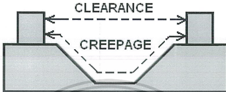
ภาพที่ 2.47 Conductor Spacing ที่มา [8]
