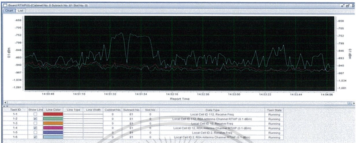
รูปที่ 4.22 ผลการเก็บค่าRTWPหลังจากปิดการใช้งาน(Block)คลื่น900MHz (On air 850MHz)
