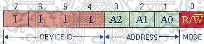
รูปที่ 2.10 I^2C BUS (Control Byte)
