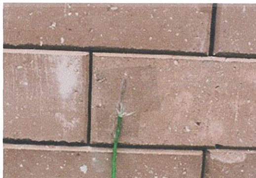
ภาพที่ 3.10 แสดงลักษณะการติดตั้ง Sensor ที่ผิวภายนอกกล่องทดลองที่ 1
