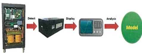
รูปที่ 3 วงจรทดสอบแบตเตอรี่เพื่อวิเคราะห์ผลตอบสนองเชิงเวลา
