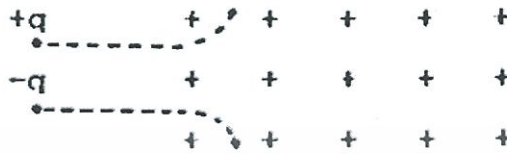
รูปที่ 2.19 ประจุต่างชนิดกันเคลื่อนที่ในทิศทางเดียวกันผ่านสนามแม่เหล็กที่ตั้งฉากกับทิศทางของการเคลื่อนที่ของประจุทั้งสอง [15]
