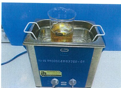
รูปที่ 3.4 แสดงภาพเครื่องอัลตราโซนิคขณะกำลังทำความสะอาดแผ่นโพลีอิมิดด้วยเมทานอล
