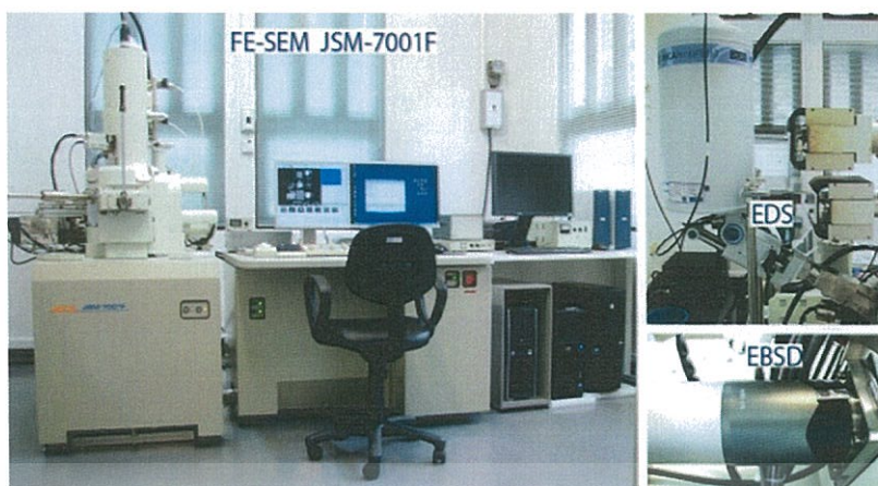
รูปที่ 2.39 กล้องจุลทรรศน์ อิเล็กตรอนแบบส่องกราด ความละเอียดสูง รุ่น JSM-7001F [37]
