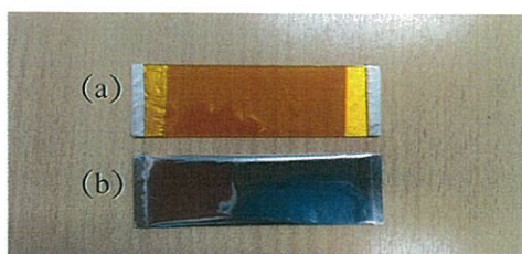
รูปที่ 2 (a) ภาพถ่ายแผ่นโพลีอิมมิดและ (b) โพลีอิมมิดที่เคลือบด้วยฟิล์มบิสมัทเทลลูไรด์
