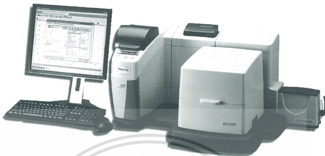
รูปที่ 3.14 เครื่อง Raman Spectrometer ของบริษัท Thermo Scientific รุ่น Thermo Scientific DXR Smart Raman spectrometer
