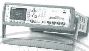
รูปที่ 3.17 เครื่อง LCR Meter ของบริษัท Agilent รุ่น E4980A
