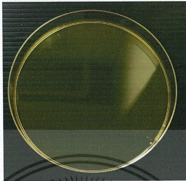
รูปที่ 4.3 การเสียสภาพของฟิล์มไคโตซานเนื่องจากกรดอะซีติกตกค้าง
