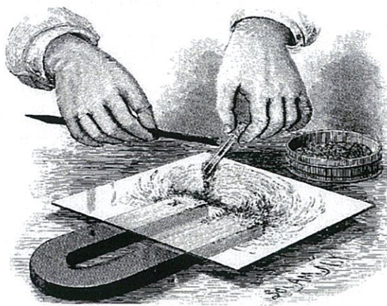
รูปที่ 2.7 การทดลองโรยผงเหล็กเพื่อดูสนามแม่เหล็ก
