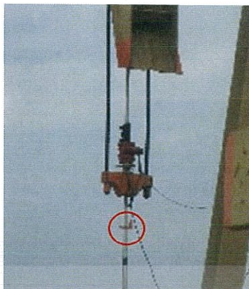
ภาพที่ 1.1 การตรวจสอบการหมุนของอุปกรณ์หมุนก้านสูบน้ำมันดิบอัจฉริยะปัจจุบันโดยการใช้ธง
