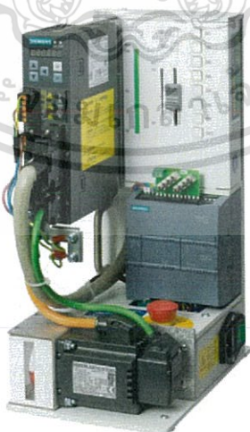
รูปที่ 3.13 ชุด Demo SINAMICS V90 Pulse train & SIMOTIC S-1FL6 with PLC S7-1200
