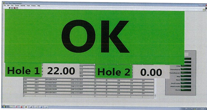
รูปที่ 3.16 ตัวอย่างหน้าจอแสดงผลเมื่อตู้เย็นเครื่องนั้นผ่านการตรวจสอบ
