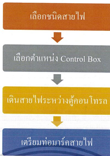
รูปที่ 3.14 ขั้นตอนการวางแผนงานระบบไฟฟ้าภายในตู้คอนโทรล
