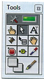
รูปที่ 2.26 Tools Palette ที่ใช้ในการออกแบบ Front Panel
