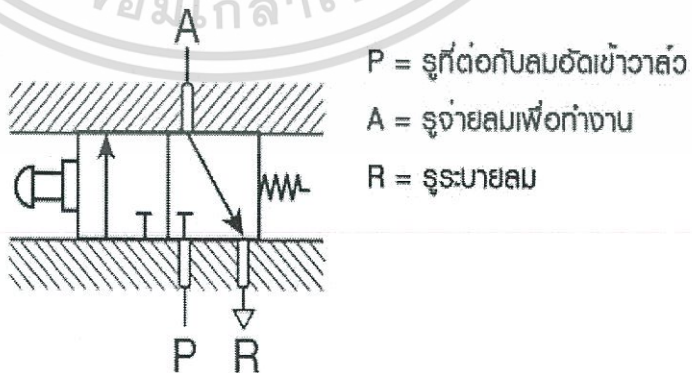
รูปที่ 2.14 การอ่านสัญลักษณ์ของวาล์วควบคุมทิศทาง
