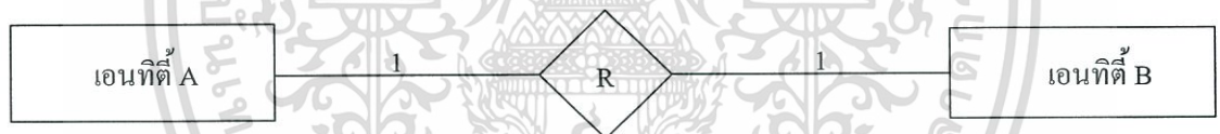
รูปที่ 2.12 แสดงตัวอย่างความสัมพันธ์แบบหนึ่งต่อหนึ่ง
