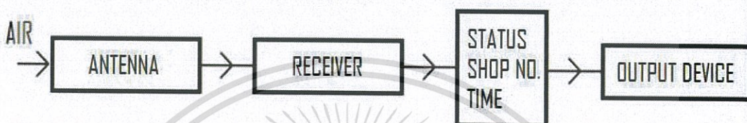
รูปที่ 3.8 บล็อกไดอะแกรมแสดงการทำงานของภาครับในระบบรถไฟ
