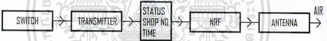
รูปที่ 3.7 บล็อกไดอะแกรมแสดงการทำงานของภาคส่งในระบบโรงอาหาร
