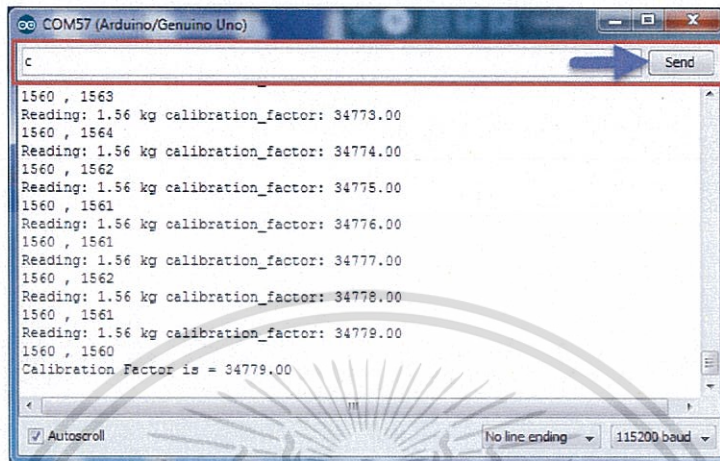
รูปที่ 3.49 การส่ง 'c' ไปเพื่อทดลองอ่านค่าน้ำหนัก
