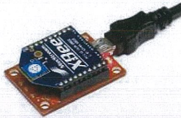
รูปที่ 3.28 การต่อ XBee เพื่อเตรียมการแก้ไขข้อมูล [28]
