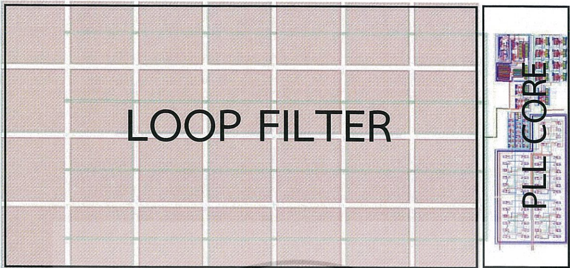
รูปที่ 4.17 วงจรทางกายภาพเฟสล็อกกลุบโดยใช้เทคนิคไปอัสตัวเอง ขนาด 130\ \mu\text{m} \times 273\ \mu\text{m}
