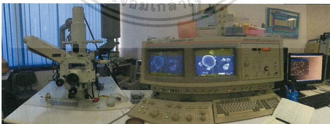
ภาพที่ ก.5 กล้องจุลทรรศน์อิเล็กตรอนแบบส่องกราด (scanning electron microscope) รุ่น JSM-6400
