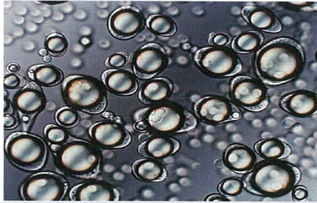
ภาพที่ 2.27 ลักษณะของการห่อหุ้มสารด้วยวิธี coacervation
