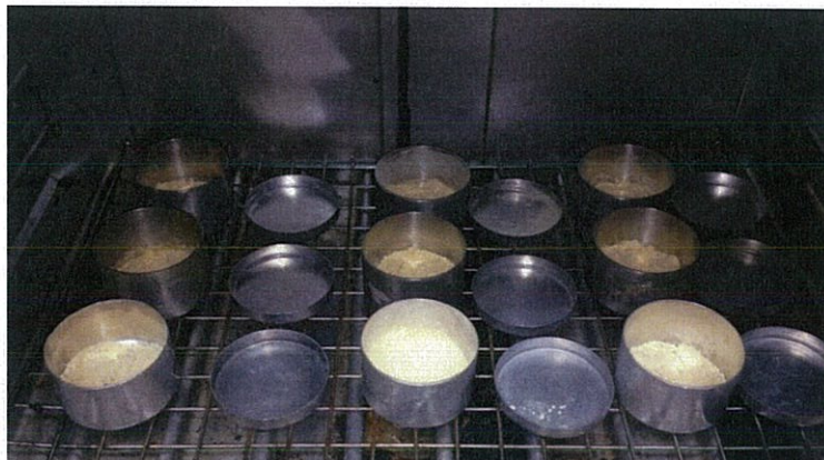
ภาพที่ ข.1 การวิเคราะห์หาปริมาณความชื้นของจิงสกัดผงด้วยตู้อบลมร้อน
