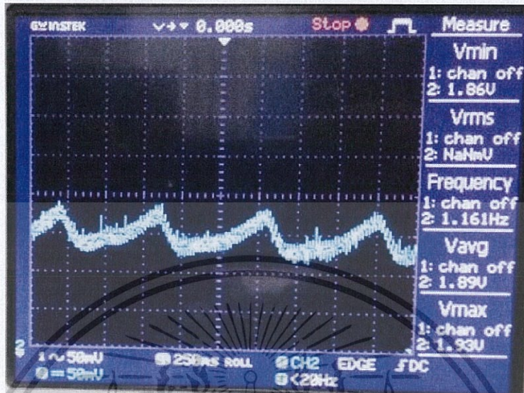
รูปที่ 4.5 สัญญาณหลังจากผ่านส่วน Transimpedance Amplifier
