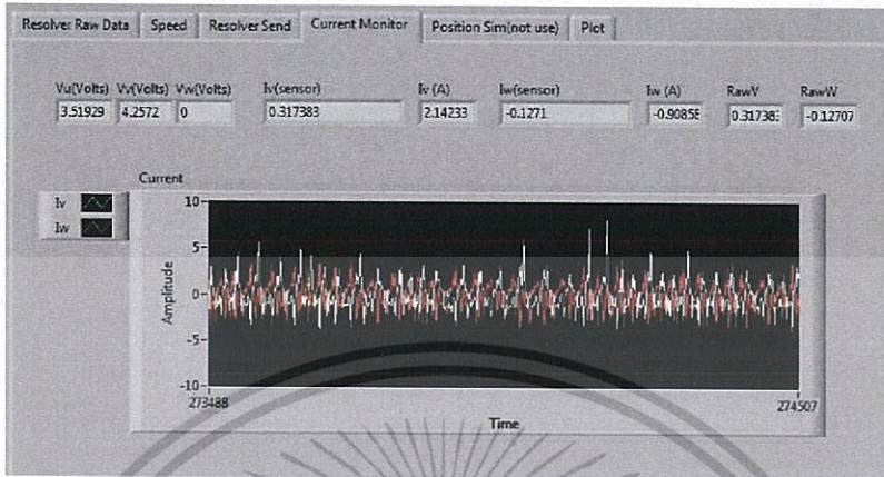
ภาพที่ 4.17 กราฟแสดงค่ากระแสที่ K_p = 0.0025 f_{cutoff} = 50 Hz และ S_p = 60\%
