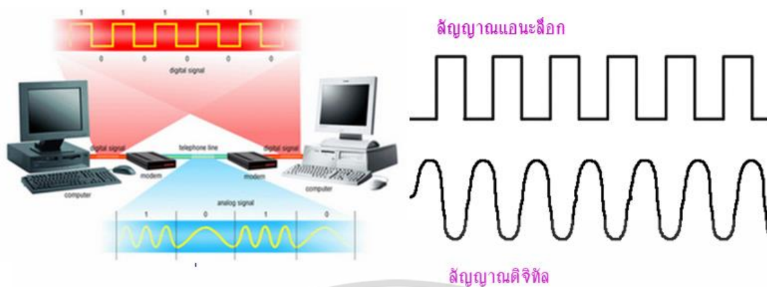
รูปที่ 2.2 สัญญาณแอนะล็อกและสัญญาณดิจิทัล
