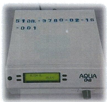
ภาพที่ ข.15 เครื่องวัด water activity ภาพที่ ข.16 น้ำ Ultra pure type I ภาพที่ ข.17 ตลับใส่ตัวอย่าง
