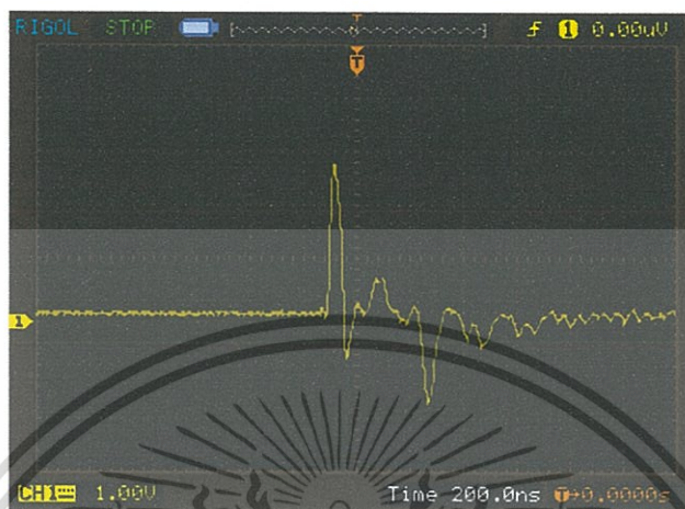
รูปที่ 4.16 สัญญาณเอาต์พุตของสายยาว 20 เมตร เมื่อ Open ปลายสาย
