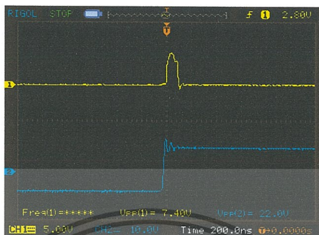
รูปที่ 4.2 สัญญาณเอาต์พุต IC#74LS221 (กราฟบน) สัญญาณอินพุต IC#74LS221 (กราฟล่าง)
