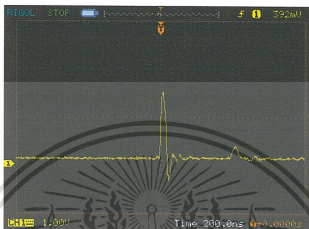
รูปที่ 4.22 สัญญาณเอาต์พุตของสายยาว 70 เมตร เมื่อ Open ปลายสาย
