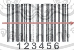
รูป 2.3 การฉายแสงลงบนแท่งบาร์โค้ดของเครื่องอ่าน
