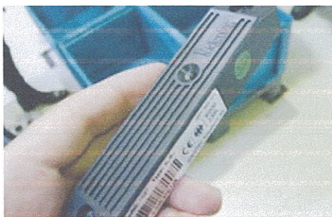
รูป 2.10 ตัวอย่างอุปกรณ์ประเภท Active Tag
