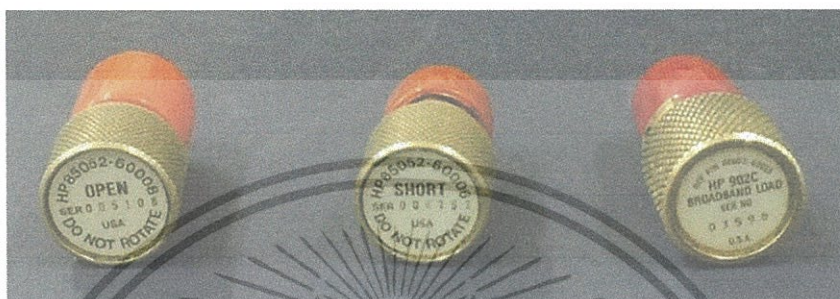
รูปที่ 3.7 ตัวปรับเทียบมี 3 ประเภทด้วยกัน OPEN, SHORT และ LOAD
