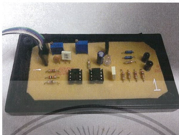
รูปที่ 3.4 วงจรตัวส่งสัญญาณอินฟราเรด
