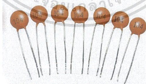
รูปที่ 2.10 ตัวเก็บประจุชนิดเซรามิก [13]
