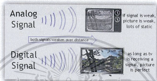
รูปที่ 2.7.2.1 ความแตกต่างคุณภาพสัญญาณภาพตามระดับความแรงของสัญญาณที่ได้รับ [11]
