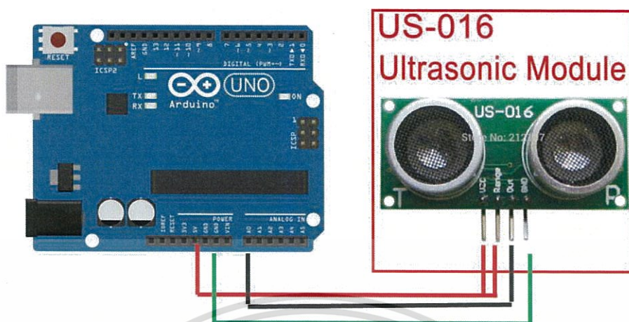
รูปที่ 3.12 โมดูลอัลตราโซนิก US-016 เชื่อมต่อกับ MCS Arduino
