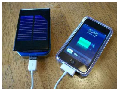
ภาพที่ 4 โซล่าเซลล์สำหรับเครื่องชาร์จโทรศัพท์มือถือ
