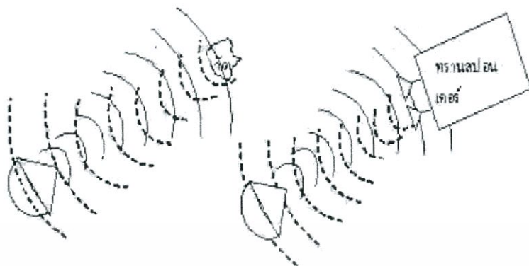
รูปที่ 2.1 เรดาร์ชนิดปฐมภูมิ (ซ้าย) และชนิดทุติยภูมิ (ขวา)
