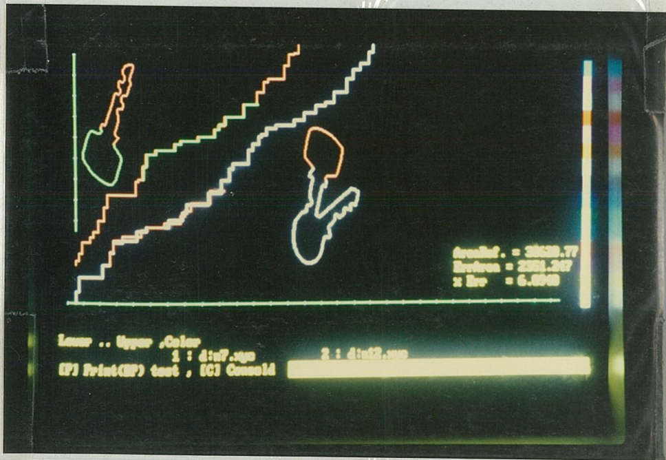
รูปที่ 5.9 แสดงถึงบริเวณที่ตรวจพบว่าขอบของวัตถุอ้างอิง (รูปที่ 5.3) มีความสมนัยกันกับขอบของวัตถุที่กำลังตรวจสอบ (รูปที่ 5.4)
