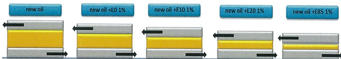
รูปที่ 4.38 รูปแบบการปนเปื้อนน้ำมันเชื้อเพลิงในน้ำมันหล่อลื่น
