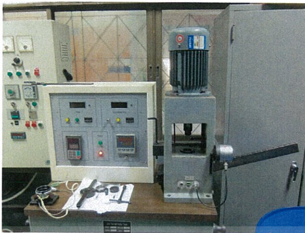
รูปที่ 3.8 เครื่องทดสอบด้านการสึกหรอชนิดโฟร์บอล (Four Ball Test)
