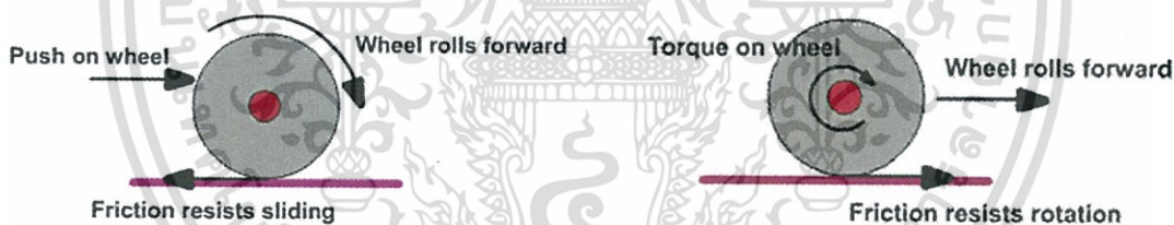
รูปที่ 2.17 แรงเสียดทานแบบกลิ้ง [23]
