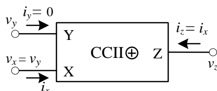
รูปที่ 3.3 สัญลักษณ์ของวงจรสายพานกระแสรุ่นที่สองชนิดบวก (CCII+)
