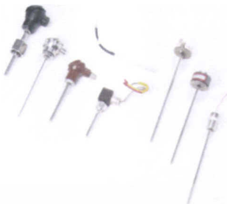
รูปที่ 2.1 อุปกรณ์ตรวจวัดอุณหภูมิแบบความต้านทาน [8]
