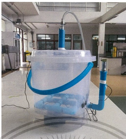
รูปที่ 3.4 เครื่องทำความเย็นแบบระเหยที่ใช้ในการทดลอง
