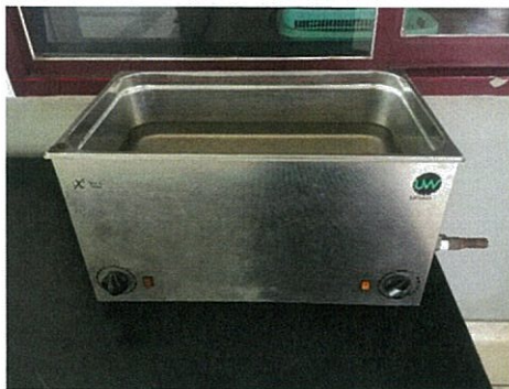
รูปที่ 3.4 เครื่องอัลตราโซนิก (Ultrasonic) รุ่น Ultrawave-U2200
