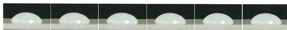
รูปที่ 4.6 ตัวอย่างมุมสัมผัสหยดน้ำของสีเบสเมื่อผสมกับน้ำมันแร่และดินเหนียว แล้วเติม TEOS
