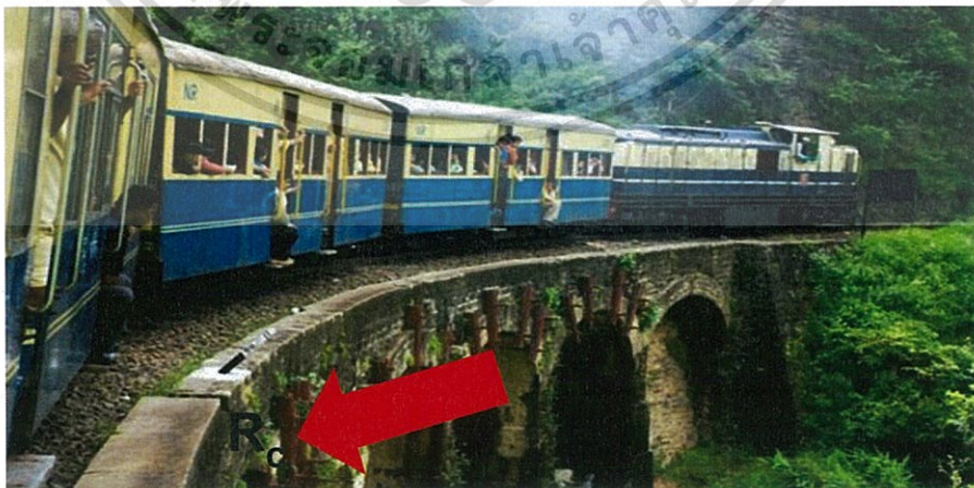
รูปที่ 2.14 แรงต้านทานขณะที่รถไฟกำลังเคลื่อนที่เข้าทางโค้ง (Curves resistance, R_C )
