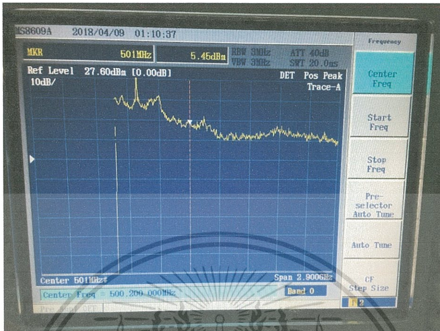
รูปที่ 4.10 ผลการทดลองวัดค่าสัญญาณที่ 500 MHz หลังเพิ่ม Amplifier Module
