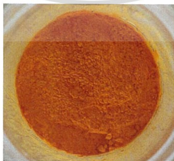
รูปที่ 4.1 ลักษณะทางกายภาพของตัวเร่งปฏิกิริยา Fe-MOF
