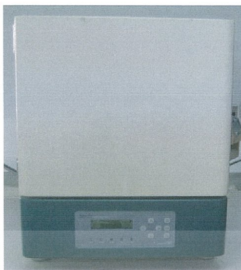
รูปที่ 3.6 เตาเผาเถ้าอุณหภูมิสูง (Muffer furnace)ยี่ห้อ JSR รุ่น JSMF-45T
