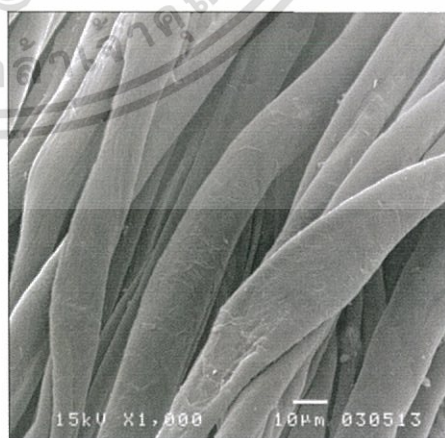
รูปที่ 4.46 ผ้าที่ผ่านการย้อมโดยใช้ฟางข้าวที่ผ่านการดัดแปลงสภาพด้วยกรดเป็นวัสดุดูดซับ สัดส่วนวัสดุดูดซับ 0.03 g/ml ที่กำลังขยาย 1000 เท่าระยะเวลาในการดูดซับ 45 นาที(ด้านซ้าย) ระยะเวลาในการดูดซับ 80 นาที(ด้านขวา)
