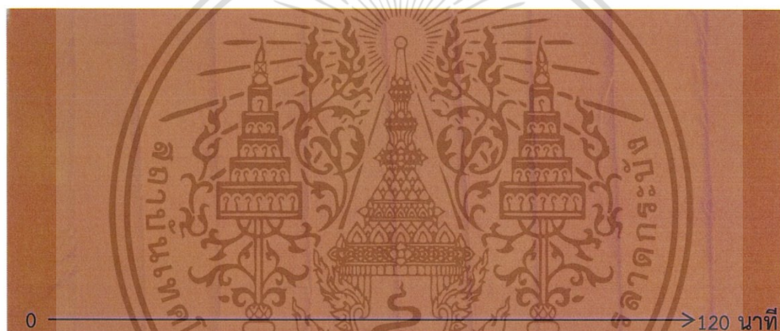
รูปที่ 4.19 ผ้าที่ผ่านการย้อมโดยใช้ฟางข้าวที่ไม่ผ่านการดัดแปลงสภาพเป็นวัสดุดูดซับในระหว่างกระบวนการย้อม สัดส่วนวัสดุดูดซับ 0.05 g/ml ที่ระยะเวลาในการดูดซับ 0-120 นาที
