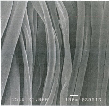
รูปที่ 4.41 ผ้าที่ผ่านการย้อมโดยใช้ฟางข้าวที่ไม่ผ่านการดัดแปลงสภาพเป็นวัสดุดูดซับ สัดส่วนวัสดุดูดซับ 0.05 g/ml ที่กำลังขยาย 1000 เท่าระยะเวลาในการดูดซับ 45 นาที(ด้านซ้าย) ระยะเวลาในการดูดซับ 80 นาที(ด้านขวา)
