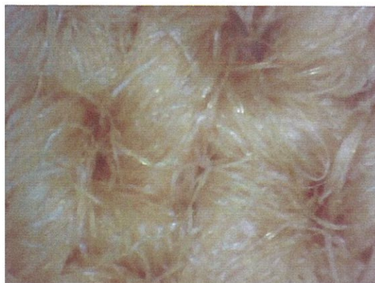
รูปที่ 4.38 ผ้าที่ผ่านการย้อมโดยใช้ฟางข้าวที่ผ่านการดัดแปลงสภาพด้วยกรดเป็นวัสดุดูดซับ สัดส่วนวัสดุดูดซับ 0.05 g/ml ที่กำลังขยาย 500 เท่าระยะเวลาในการดูดซับ 45 นาที(ด้านซ้าย) ระยะเวลาในการดูดซับ 80 นาที(ด้านขวา)
