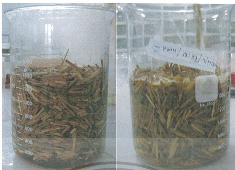
รูปที่ 3.1 การปรับสภาพฟางข้าวด้วยการแช่ในสารละลายกรดซัลฟิวริก (ซ้าย) และในสารละลายโซเดียมไฮดรอกไซด์(ขวา)
