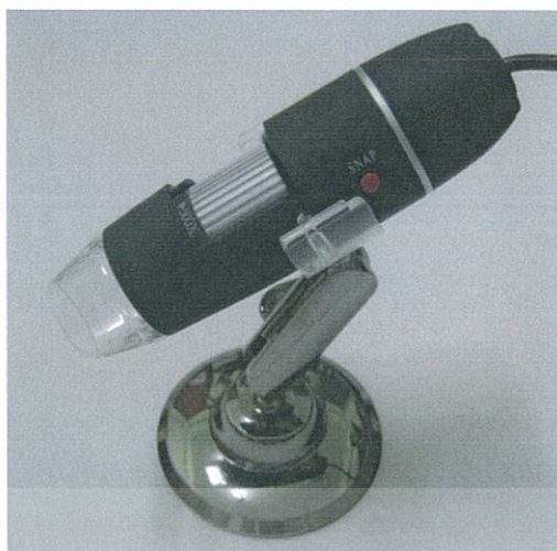
รูปที่ 3.4 กล้องดิจิทัลออปติคอลไมโครสโคป(Digital Microscope) รุ่น USB S02
