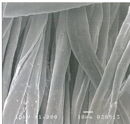
รูปที่ 4.44 ผ้าที่ผ่านการย้อมโดยใช้ฟางข้าวที่ผ่านการดัดแปลงสภาพด้วยเบสเป็นวัสดุดูดซับ สัดส่วนวัสดุดูดซับ 0.05 g/ml ที่กำลังขยาย 1000 เท่าระยะเวลาในการดูดซับ 45 นาที(ด้านซ้าย) ระยะเวลาในการดูดซับ 80 นาที(ด้านขวา)
