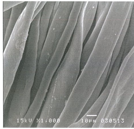
รูปที่ 4.41 ผ้าที่ผ่านการย้อมโดยใช้ฟางข้าวที่ไม่ผ่านการดัดแปลงสภาพเป็นวัสดุดูดซับ สัดส่วนวัสดุดูดซับ 0.05 g/ml ที่กำลังขยาย 1000 เท่าระยะเวลาในการดูดซับ 45 นาที(ด้านซ้าย) ระยะเวลาในการดูดซับ 80 นาที(ด้านขวา)
