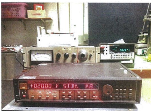
รูปที่ 3.7 แสดงภาพถ่ายอุปกรณ์ที่ใช้วัดปรากฏการณ์ฮอลล์
