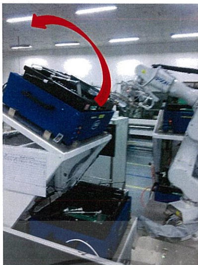
รูปที่ 4.6 แขนกลส่งฟีกเจอร์ให้เปิดฝา
