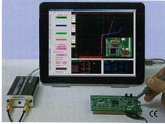
รูปที่ 2.45 การทดสอบด้วยการวัดแรงดันไฟฟ้า (Analog signature analysis)
