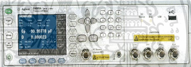
รูปที่ 3.11 แสดงอุปกรณ์ที่ใช้ศึกษาสมบัติเฉพาะของไคโอตด้วยการวัดความสัมพันธ์ระหว่างค่าความจุไฟฟ้า-แรงดันไฟฟ้า (C-V curve) และอิมพีแดนซ์สเปกโตรสโคปีที่อุณหภูมิต่างๆ ในช่วง 20-300 เคลวิน
