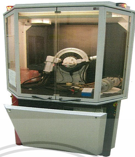
รูปที่ 3.5 แสดงเครื่องเอกซเรย์ดิฟแฟรคโตรมิเตอร์ยี่ห้อ Bruker รุ่น D8 advance
