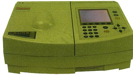
รูปที่ 3.7 แสดงเครื่อง UV-VIS spectrophotometer ยี่ห้อ thermo electron corporation รุ่น Heios
