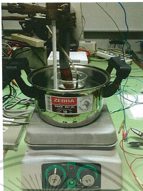
รูปที่ 3.12 แสดงอุปกรณ์ที่ใช้ในการศึกษาสมบัติเฉพาะของไดโอดด้วยการวัดกราฟความสัมพันธ์ระหว่างค่าความจุไฟฟ้ากับความถี่ และการวัดอิมพีแดนซ์สเปกโตรสโคปีที่อุณหภูมิ 25-90 องศาเซลเซียส
