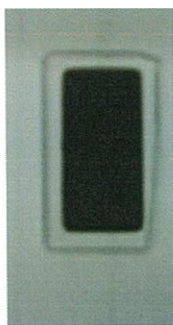
รูปที่ 4.1 แสดงฟิล์มบางของสารกึ่งตัวนำ ZnTe ที่เคลือบอยู่บนแผ่นฐานรองรับที่เป็นแผ่นกระจกสไลด์ซึ่งเตรียมโดยวิธีการระเหยสารเคมีด้วยความร้อนในระบบสุญญากาศ เมื่อไม่มีการแอนนีก
