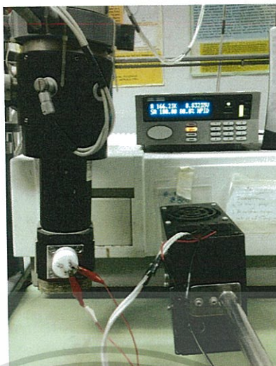
รูปที่ 3.10 แสดงภาพถ่ายของไคโอสแตตที่ใช้ศึกษาสมบัติเฉพาะของไคโอตด้วยการวัดกราฟความสัมพันธ์ระหว่างค่ากระแสไฟฟ้า-แรงดันไฟฟ้า (I-V curve) ที่อุณหภูมิต่างๆ ในช่วง 20-300 เคลวิน
