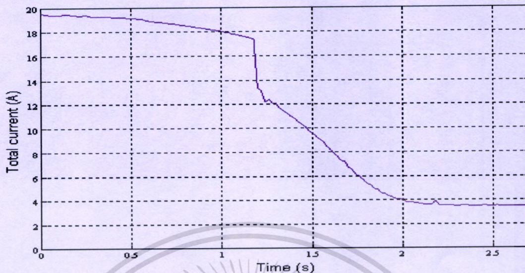
รูปที่ 4.26 กราฟความสัมพันธ์ระหว่างกระแสและเวลาของมอเตอร์ Capacitor start ขนาด 1/2 แรงม้า เมื่อทดสอบกับล้อช่วยแรงขนาด 0.09339 \text{ kg-m}^2
