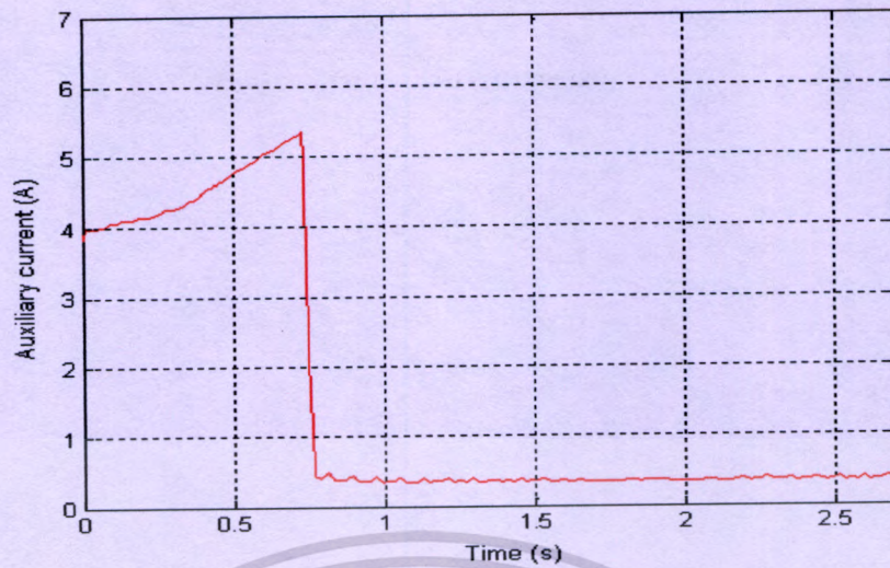
รูปที่ 4.62 กราฟความสัมพันธ์ของแรงบิดและกระแสของมอเตอร์ capacitor start ขนาด 1/4 แรงม้าในช่วงที่มอเตอร์เร่งความเร็วเมื่อทดสอบกับล้อช่วยแรงขนาด 0.0325 \text{ kg-m}^2
