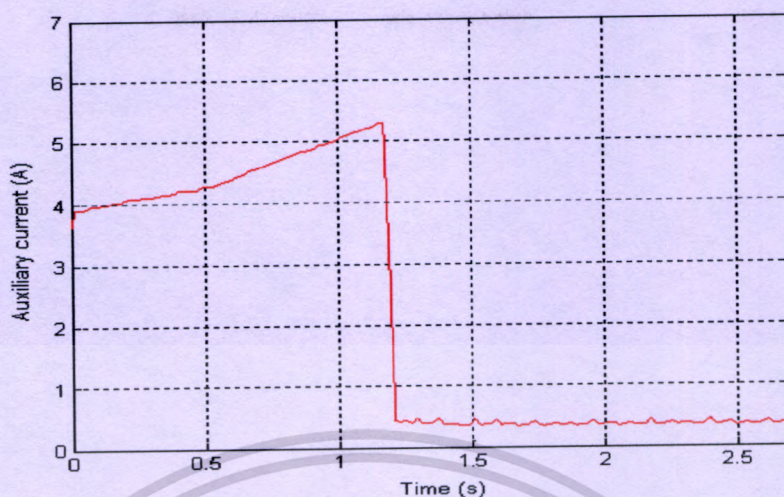
รูปที่ 4.64 กราฟความสัมพันธ์ของแรงบิดและกระแสของมอเตอร์ capacitor start ขนาด 1/4 แรงม้าในช่วงที่มอเตอร์เร่งความเร็วเมื่อทดสอบกับล้อช่วยแรงขนาด 0.0523 \text{ kg-m}^2
