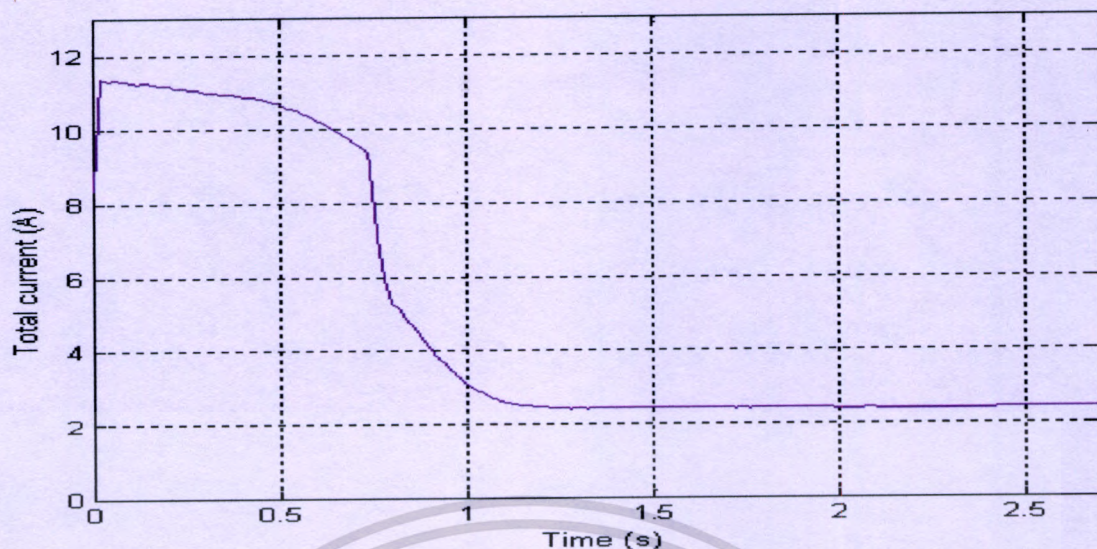
รูปที่ 4.30 กราฟความสัมพันธ์ระหว่างกระแสและเวลาของมอเตอร์ Capacitor start ขนาด 1/4 แรงม้า เมื่อทดสอบกับล้อช่วยแรงขนาด 0.0325 \text{ kg-m}^2
