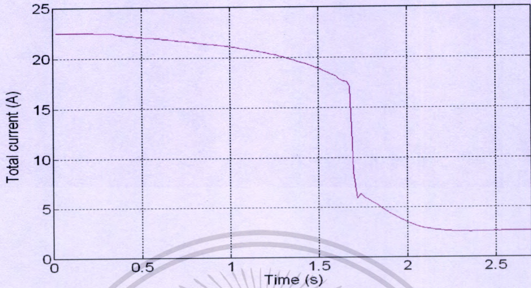
รูปที่ 4.28 กราฟความสัมพันธ์ระหว่างกระแสและเวลาของมอเตอร์ Split phase ขนาด 1/4 แรงม้า เมื่อทดสอบกับล้อช่วยแรงขนาด 0.04598 \text{ kg-m}^2
