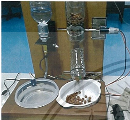
รูปที่ 20. การจ่ายอาหารของเครื่องให้อาหารสัตว์อัตโนมัติ
