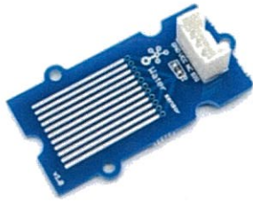
รูปที่ 4. เซ็นเซอร์ตรวจจับน้ำ
