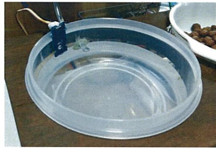
รูปที่ 22. การหยุดการจ่ายน้ำของเครื่องให้อาหารสัตว์อัตโนมัติ
