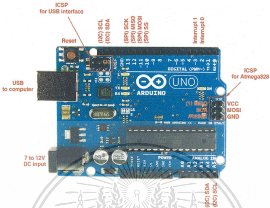
รูปที่ 2.2 ส่วนประกอบแผงวงจร Arduino Uno R3
